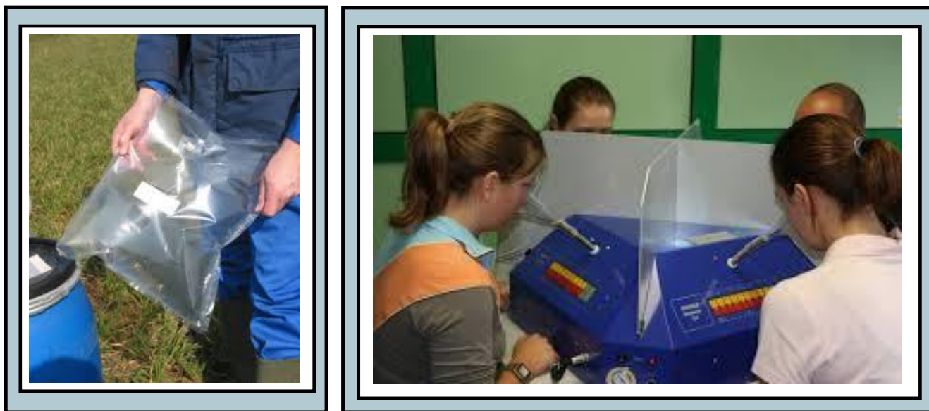
Figur 1. Lugtbestemmelsen er gennemført ved udtagning af lugtprøver i lugtposer (billedet tv.). Lugtkoncentrationen i de udtagne prøver bestemmes efterfølgende ved ofaktometrisk analyse med lugtpaneler på lugtlaboratorium (billedet th.).
